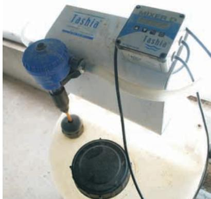
Dosificador portátil. Permite medicar automáticamente la línea o nave que así lo precise.
