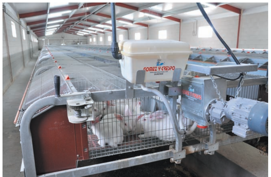
Sistema de apertura y cierre de los nidales para la lactación controlada
